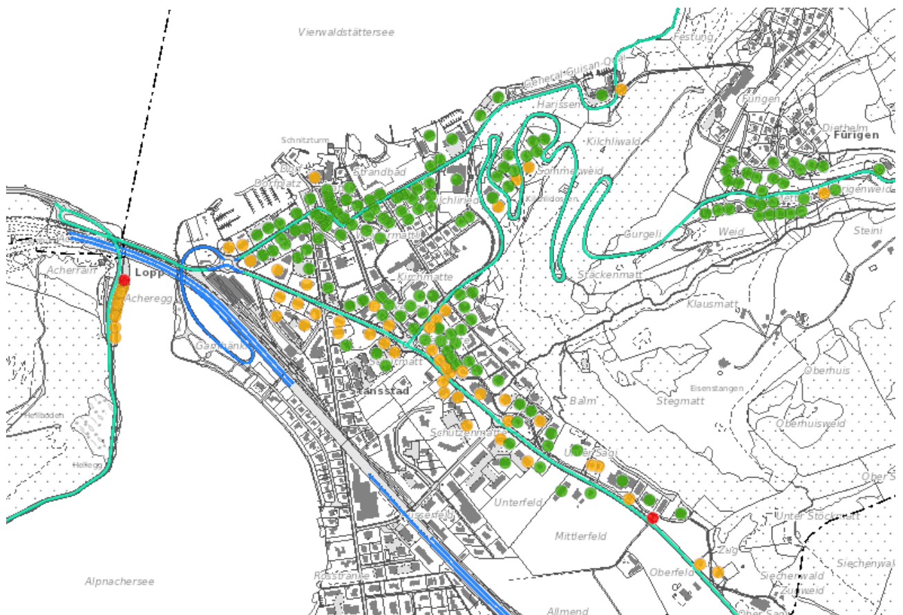
Abbildung 21: Auszug Lärmbelastungskataster Kanton Nidwalden. Die orangen Kreise zeigen Liegenschaften, wo der Immissionsgrenzwert überschritten ist. (Quelle: gis-daten.ch)
